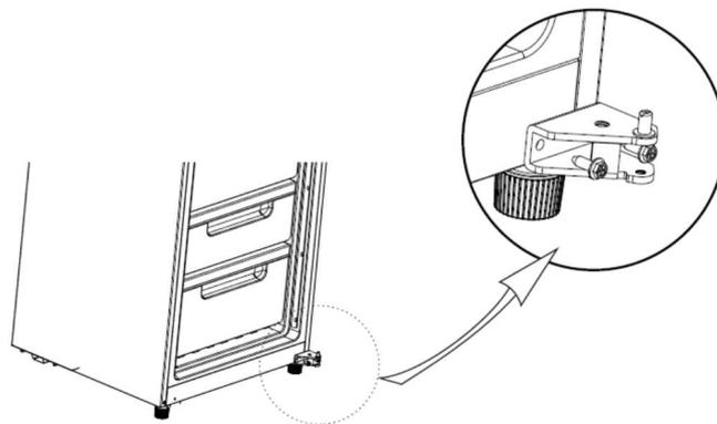
4) Vire a dobradiça inferior direita, desmonte o eixo da dobradiça e instale-o do outro lado (Fig. a), depois instale essa dobradiça no lado inferior esquerdo do refrigerador (Fig. b)
