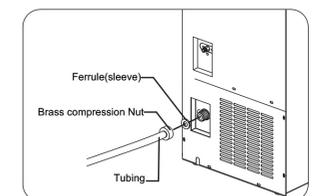
Fig. B - Ponteira (manga) – compressão de porca de latão – tubulação - comutador.
