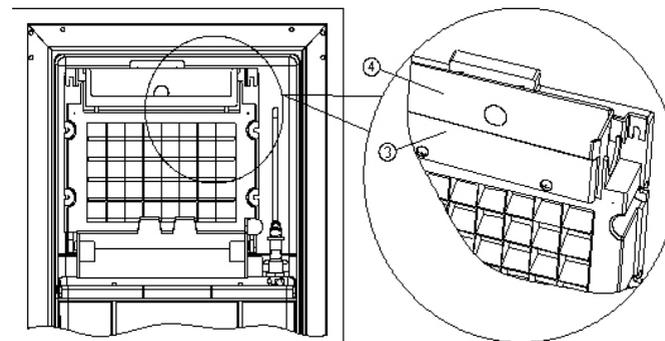
(1) Placa de cobertura da máquina de fazer gelo. (2) Suporte da placa de cobertura da forma de gelos.
