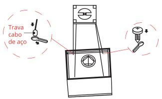
Ajuste os quatro parafusos, ao mesmo tempo, para nivelar a coifa, deixe os 4 cabos de aços ajustados e forçados uniformemente.
