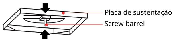
Insira o screw barrel na placa de sustentação e utilize 2 parafusos M10 de porcas para fixar screw barrel na placa de sustentação na posição superior e inferior.
