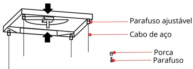
Instale os 4 parafusos ajustáveis para a placa de sustentação, parafuse para o comprimento adequado e não deixe muito apertado.
