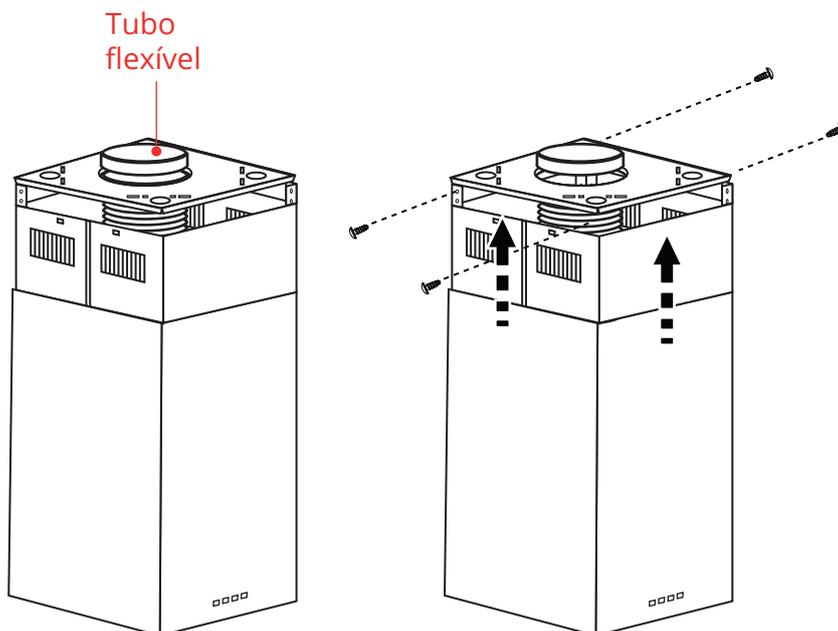
Utilize 16 parafusos M4 X 10 mm para fixar o duto superior no suporte da armação de ferro, suspendendo-o.
