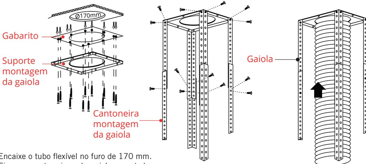
Encaixe o tubo flexível no furo de 170 mm.
