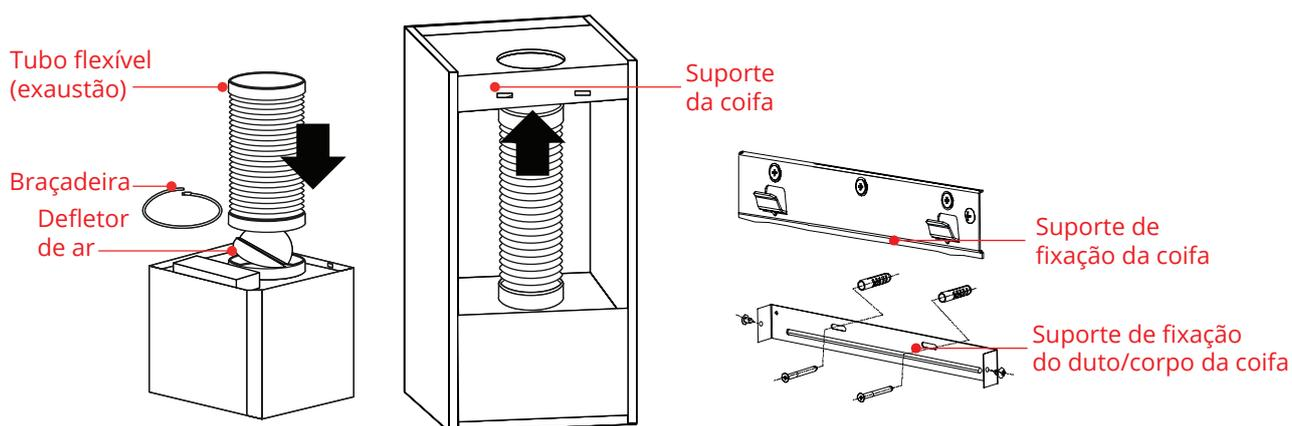
Instale o tubo de exaustão fixando-o na de saída de ar com a braçadeira plástica e o duto na Coifa; Fixe o suporte no duto externo e certifique-se de que o duto interno e o tubo de extensão possam ser instalados na altura livremente;
