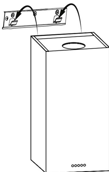
Encaixe a coifa nos ganchos do suporte de fixação instalado na parede.
