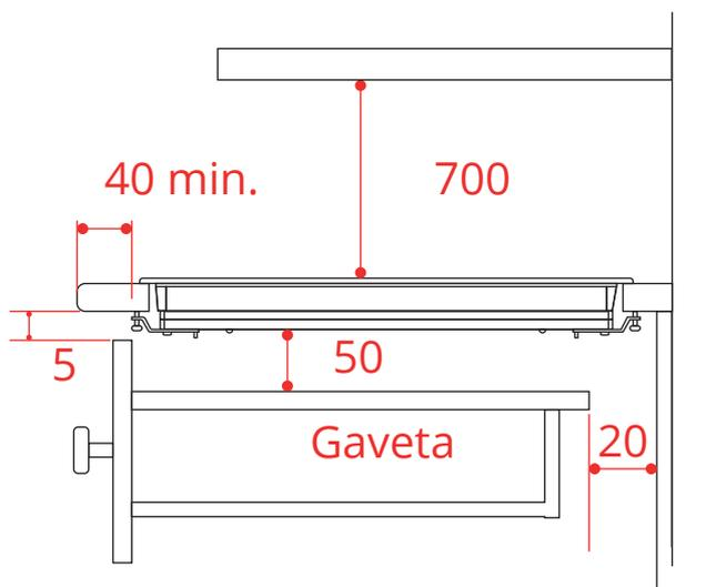
A sua profundidade deve ter a mesma largura do móvel. Na parte traseira do móvel é necessário fazer uma abertura de 20 mm de modo a permitir a troca de calor.
