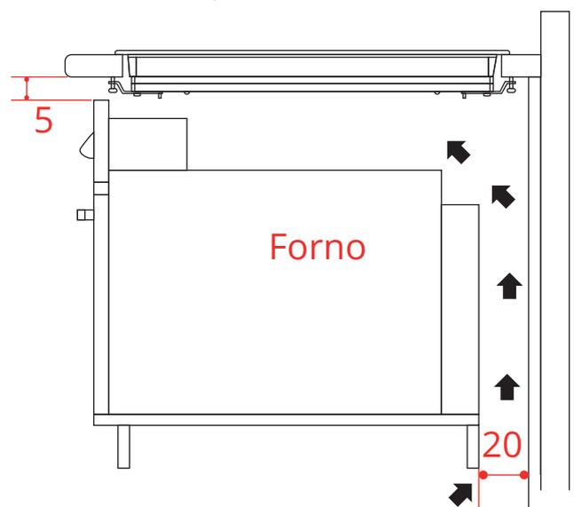
A sua profundidade deve ter a mesma largura do móvel. Na parte traseira do móvel é necessário fazer uma abertura de 20 mm de modo a permitir a troca de calor.
