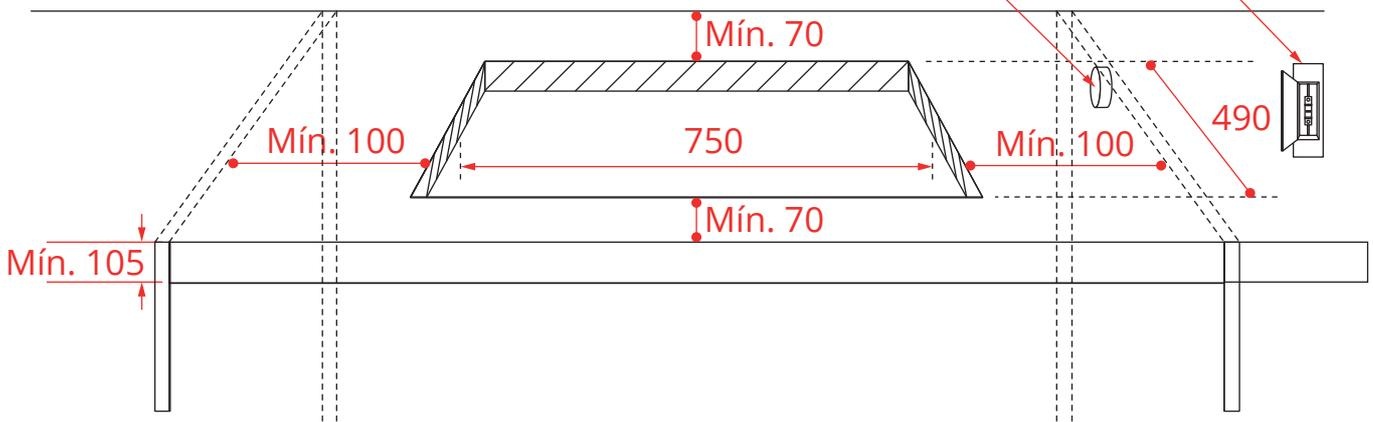
A distância mínima entre a parte inferior dos móveis, ou do exaustor colocado sobre o cooktop, deve ser no mínimo de 700 mm. Se as instruções de instalação do exaustor indicarem uma distância superior, esta deve ser respeitada.
