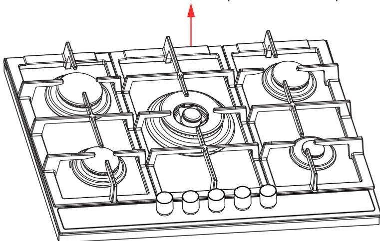
O ponto de conexão do botijão de gás ou do gás canalizado devem estar localizado no máximo a 1 m do centro do cooktop, em local de fácil acesso para permitir a conexão e inspeção.
