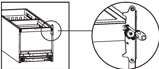
5. Inverta os pinos de apoio da porta da base das dobradiças inferior e posterior utilizando-se de uma chave inglesa.
