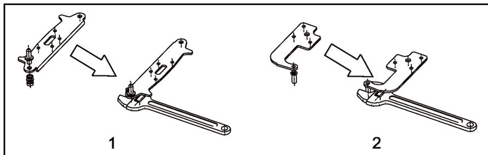
6. Instale a dobradiça inferior na base do refrigerador com uma chave de fenda cruzada (Philips) e coloque os pés de apoio conforme o desenho.
