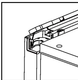
2. Feche a porta, retire o parafuso da tampa superior usando a chave de fenda. Retire a tampa superior e a tampa da dobradiça, tire o terminal do conector, e então com uma chave de fenda cruzada (Philips) retire os três parafusos da dobradiça. Assegure-se de que a porta está fechada, nesta fase a porta fica presa apenas pela borracha magnética.
