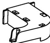
1. Desligue o plugue da tomada de força, abra a porta do compartimento do refrigerador e retire a capa de plástico usando a chave de fenda reta. Atenção para a fiação interna.
