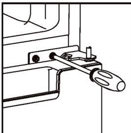
4. Incline o refrigerador em aproximadamente 45° ou deitado para trás (**lembrando que após o término da operação, deve-se aguardar pelo menos 4 horas antes de ligar a unidade novamente**), remova a base de ajuste como mostrado abaixo, depois retire a dobradiça inferior com uma chave philips.
