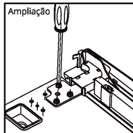
3. Retire a porta superior, depois os dois parafusos da dobradiça do meio com a chave de fenda cruzada, e então retire a porta inferior.
