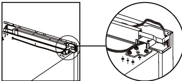
11. Fixe a tampa plástica e realize a conexão do terminal.
