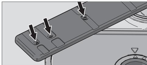
Para facilitar a limpeza, é possível remover os braços de pulverização. Depois, lembre-se de encaixá-los firmemente no lugar.
