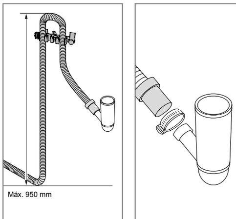
A mangueira de drenagem também pode ser conectada a um bico de conexão no sifão da pia. O bico de conexão deve ter um diâmetro interno de, no mínimo, 14 mm.
